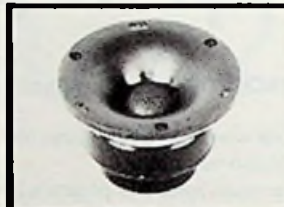
DMR 16 HiFi-middentoon koepelmembraan model, 60-100 W, 450-15000 Hz, ø 120 mm. Voor inbouw vanaf de voorzijde.
